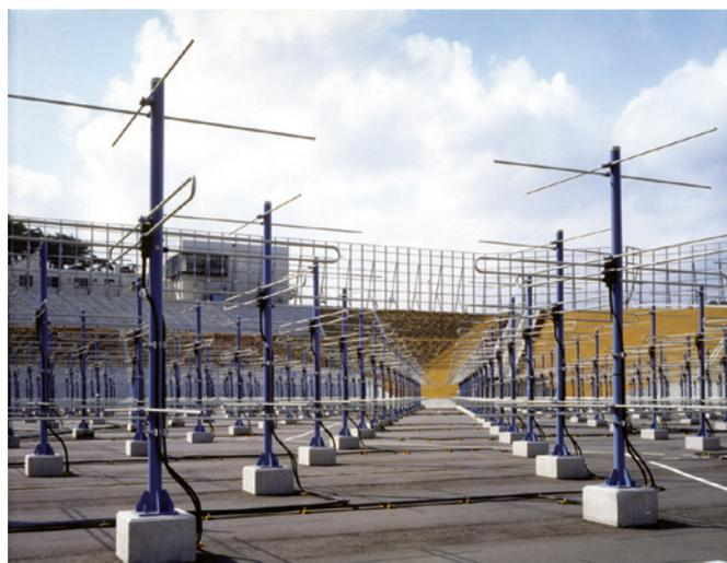
図29 地上にズラリと並ぶクロスハム・宇田アンテナには、それぞれ半導体小型送受信機が取り付けられ、電波の送信と受信を行うことができる。MUレーダーは本来、上空の風や大気の乱流の立体構造を観測するための装置だが、大気中の流星（ヘッド・プラズマ）がMUレーダーの使用周波数の電波を反射することから流星観測も可能だ。
