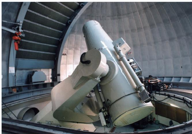
図26 木曾観測所のシュミット望遠鏡は、口径105cm、焦点距離330cmという仕様で、きわめて明るい視野を持つ。同形式の光学系としては世界第4位の口径である。現在は完全にリモートでの運用が可能となっており、トモエゴゼンによる自動観測が行われている。
