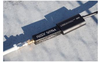
図10 ダイポールアンテナから伸びる同軸ケーブルにSDRドングルを接続し、さらにUSBリピーターで階下の窓から屋内に引き込んでいる。PCからのノイズがSDRドングルに影響を与えるケースもあるらしく、SDRドングルはPCのUSBポートに直接差すよりも、ハブやリピーターで少し離れたほうがよいこともあるという。
