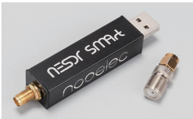
図06 SDR Dongleは、Nooelec社製のNESDR SMARt v4 SDRを使用。インターネットの通販で4000円程度で購入できた。いろいろなタイプのSDRが販売されているが、温度変化による受信周波数変動を抑えることができる温度補償型水晶発振器（TCXO）内蔵機種がお勧め。また、SDR DongleのアンテナコネクタがSMA（オス）で、自作するアンテナのコネクタがF型（メス）なので、変換アダプタ（400円程度）も同時に購入した。
