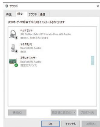
図14 PCの内部で、SDRSharpからMROFFTへ音声を流すにはステレオミキサーを有効にする必要がある。
