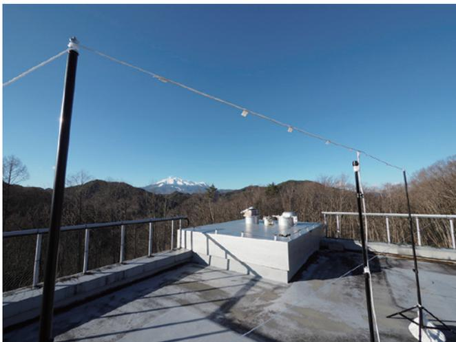
図09 木曾観測所の夜天光観測棟屋上に設置した流星電波観測用の自作ダイポールアンテナ。背景の雪を被った山は木曾御岳だ。アンテナを設置する方位角は、以下の国土地理院のサイトを用いて算出した (<https://vldb.gsi.go.jp/sokuchi/surveycalc/surveycalc/bl2sf.html>)。また、送信場所である福井県立大学と観測地である木曾観測所の緯度経度は、Google マップを利用して取得した。ちなみに木曾観測所からの福井県立大学の方位は真北から東回りに286度強(すなわち真西から北側に約16度)、距離は126kmほどである。
