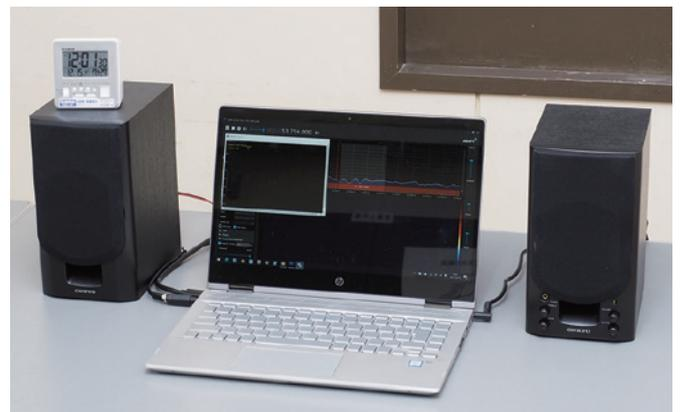
図12 セットアップされたノートPC。流星の出現を音で聞くために外付けのスピーカーを用意して、PCのヘッドホン端子に接続している。流星が出現すると、「コツ」や「コーン」という音で知らせてくれる。
