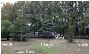
図24 アンテナはクロス八木・宇田アンテナを5基、東西南北の方位に合わせて十字に並べている。東西、南北のアンテナの間隔は、同じにしてしまうと中央のアンテナとの位相差が等しくなってしまうので、それぞれ一方は観測波長と同じ(1.0λ)、もう一方は1.5倍(1.5λ)として、電波のやってくる方向をより正確に検出できるようにしている。
