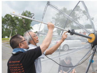
図03 パラボラ面が完成し、いよいよ受信フィードの取り付け。ここで、問題発生だ。このパラボラの焦点位置を忘れてしまったという石黒先生。しかし、さっと方程式を解き、パラボラ面の底からの長さを算出し、事なきを得た。
