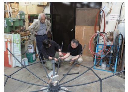
図04 だいぶ形になってきたパラボラ面の骨組み。ここでひとつ問題発生。骨組みを完成させると、なんと工作室のドアから外に出せそうにないことに気が付いた。とりあえず、骨組みを完成させて、再度一部を分解して運び出すことに……。
