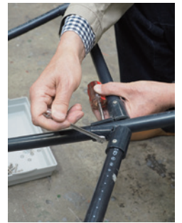
図03 放射状に配置されたパイプは、外側の一端をスチールワイヤーで中央部に引っ張り、湾曲させることで近似的にパラボラ面を作っていく。パイプの中間には塩ビパイプの継ぎ手を利用して補強のためのステーを装着。固定にはパイプと継ぎ手に穴を空けてボルトで共締めだ。
