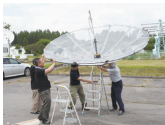
図02 2枚の金網を重ねて、いっしょに細い針金で塩ビパイプの骨組みに縛り付けていく地道な作業。
