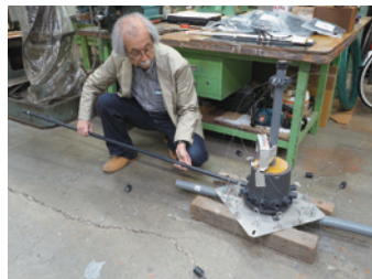
図02 パラボラアンテナの中心部は、アルミ板とその上に逆さまに伏せたプラスチック製の植木鉢がベースとなっている。アルミ板の下の鉄パイプは、パラボラアンテナの仰角を動かすための回転軸だ。植木鉢の外周を取り巻くように塩ビパイプ用の継ぎ手を固定して、パラボラ面の骨組みを構成する塩ビパイプの片端を差し込んでいく。この時点で、すでにアンテナ直径は4mではなく、3mであることが発覚！
