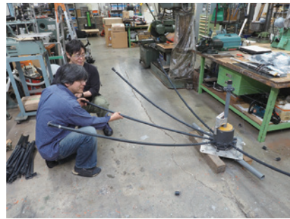
図03 放射状に配置されたパイプは、外側の一端をスチールワイヤーで中央部に引っ張り、湾曲させることで近似的にパラボラ面を作っていく。パイプの中間には塩ビパイプの継ぎ手を利用して補強のためのステーを装着。固定にはパイプと継ぎ手に穴を空けてボルトで共締めだ。
