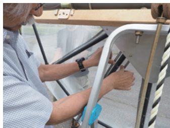
図01 まずは、パラボラ面作り。スタッフ総出で金網を固定していく。
