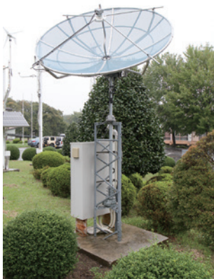
図01 駒ヶ根工業高校の敷地のほぼ中央、正面玄関前に1.8mのパラボラアンテナを広げる太陽電波望遠鏡。2013年の設置後、卒業生の意思を継いだ在校生たちによって、メンテナンスはもちろん、より性能アップのための改修も施されている。
