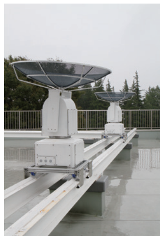
図01 建築されてから間もない情報技術科棟の屋上には、最初から電波干渉計用としてのレールを載せる台座が組み付けられていて、すでにレールは完成済み。設置は駒ヶ根工業高校にゆかりのある鉄工所が行った。レールは東西に15m、南北に11mの長さ。高さは0.1mm以内の精度で水平に固定されているという。
