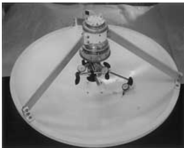
図2(a). 主鏡と副鏡の軸合わせに用いる治具の全景.
