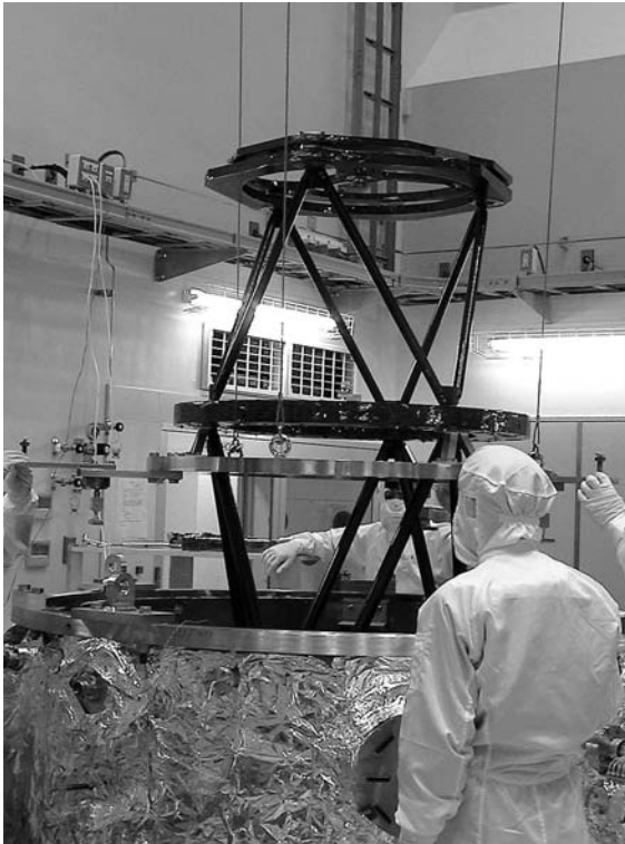
図4. CFRP構体のベーキング準備
