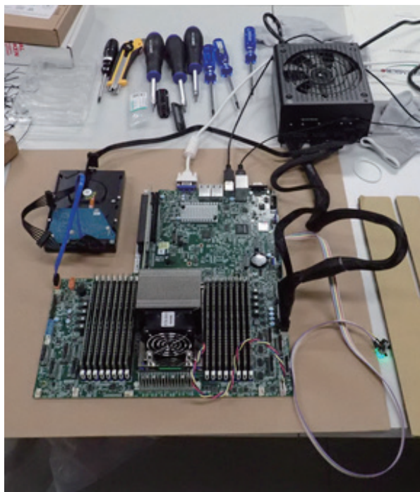
図3：AMD EPYC ノード組立後の様子。
