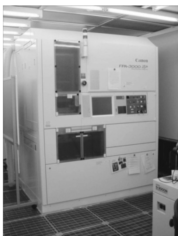
図1-1. i線ステッパ (Canon FPA-3000 i5+) 波長365nmの紫外線で露光する装置。解像度はLine and Space 0.35 \mu mである。
