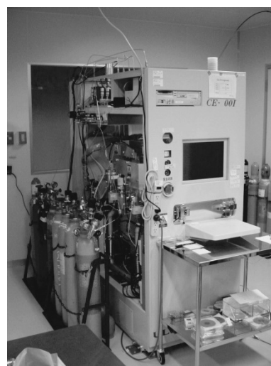
図1-3. ICP (Inductively Coupled Plasma) エッチング装置 (ULVAC CE300I)
