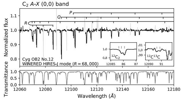
図1. 荒木望遠鏡/WINERED（神山天文台）で取得されたCyg OB2 No.12のC<sub>2</sub> A-X(0,0) bandの近赤外高分散スペクトル（上パネル）。強い大気吸収線（下パネル）によりノイズが高い波長域は薄いグレーで表示している。3つの速度成分を分解して各回転遷移の吸収線を検出できている（上パネル内の拡大図左）。また、<sup>12</sup>C<sup>13</sup>C（上パネル内拡大図）による微弱な吸収を検出できている[1]。
