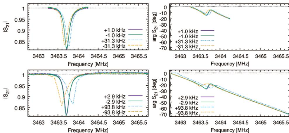
図1. 周波数掃引により得られた共振スペクトルの例。透過特性 $S_{21}$ の振幅 (左) と位相 (右)。掃引幅は1 MHz (上) と3 MHz (下)。掃引速度が最も遅いものと速いものを示している。凡例は周波数掃引の刻み幅を示す。
