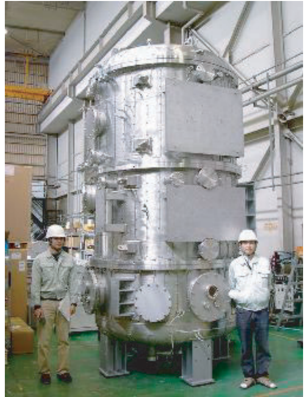
図8. 熱光学試験真空チャンバー
