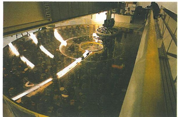
写真3 コントラベス社のワンパン地下工場（ピツバーグ近郊）において表面研磨中の8m主鏡。
