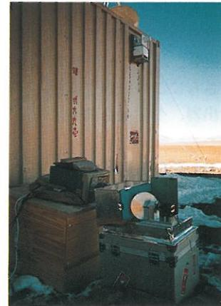
図 1 Rio Frio (4100 m) における 492 GHz / 220 GHz 大気透過率同時測定の様子。
