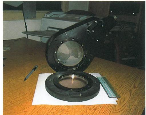
図 2 偏光器ハードウェア (波長板、回転モジュール、偏光子)。
