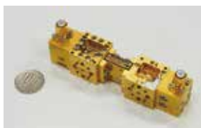
周波数ミキサを連結した、新しい概念の超伝導マイクロ波増幅器。
