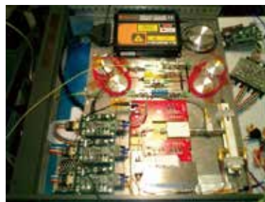
レーザー光をテラヘルツ周波数の電波に変調するフォトニック技術。従来より1桁安定度が高い性能を実現。
