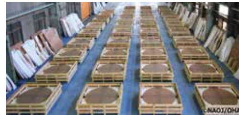
日本が製造を分担する主鏡分割鏡材には、熱膨張率がほぼゼロの特殊なガラスを使い、2024年までに356枚が製造されています。
