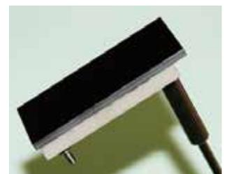
赤外線に感度の高いメガピクセルCCD (2,048×4,096ピクセル/受光面は3cm×6cm角)。
