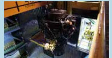
超広視野多天体分光器（Prime Focus Spectrograph：PFS）は、すばる望遠鏡の主焦点に設置する分光装置です。直径1.3度の超広視野の中にある天体を一度に最大2,394個も分光観測することができます。画像は、すばる望遠鏡のドーム内に敷設された分光器の1台目（上）と、超広視野カメラの補正レンズとともに望遠鏡主焦点に搭載される主焦点装置（下）です。（PFSプロジェクト提供）
