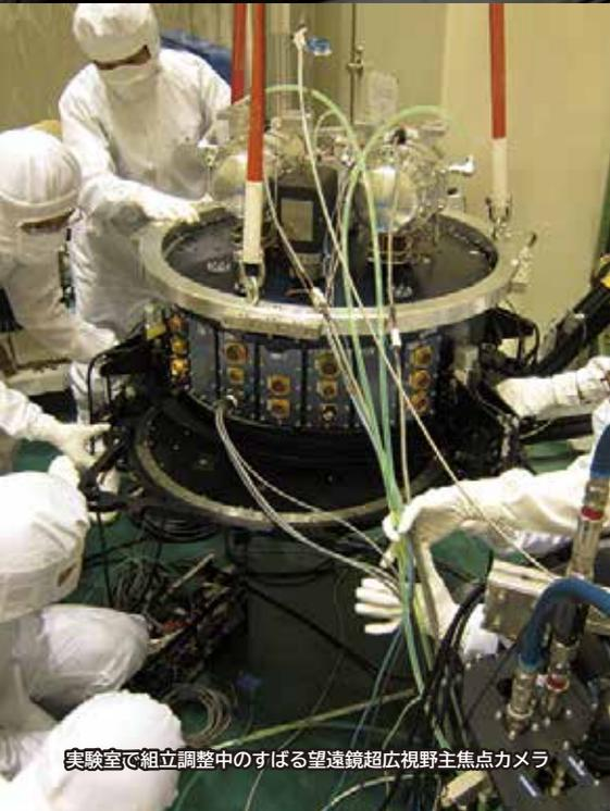
実験室で組立調整中のすばる望遠鏡超広視野主焦点カメラ
