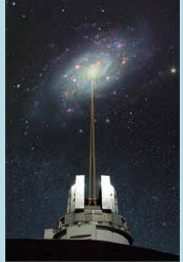
広視野補償光学では、4本のレーザーを上空に打ち上げて上層大気を光らせ、人工の星（レーザーガイド星）を作ります。それらの光を使って、大気揺らぎを測定・補正します。（概念図）
