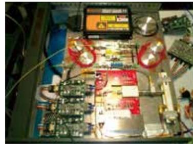
レーザー光をテラヘルツ周波数の電波に変調するフォトニック技術。従来より1桁安定度が高い性能を実現。
