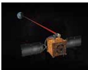
衛星光通信の模式図。Credit: NASA/JPL
