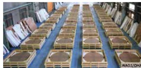
日本が製造を分担する主鏡分割鏡材には、熱膨張率がほぼゼロの特殊なガラスを使い、2024年までに356枚が製造されています。
