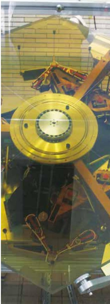
日本で製作された主鏡分割鏡の試作品の中央部の拡大画像。全体は六角形状です。鏡材の下に見えるのは、主鏡の形状を精密に制御するための支持機構。実際に鏡にする際には、表面に銀のコーティングを施します。
