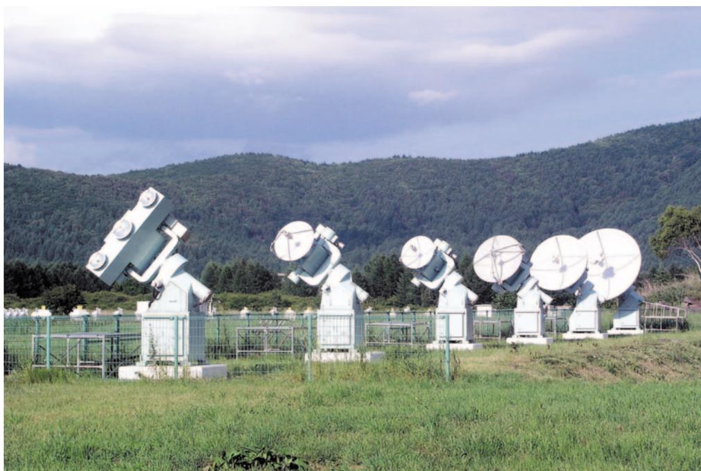
図2. 偏波強度計アンテナ群
