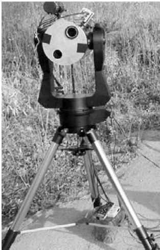
図 12. 実際に測定に使用しているDIMM.
