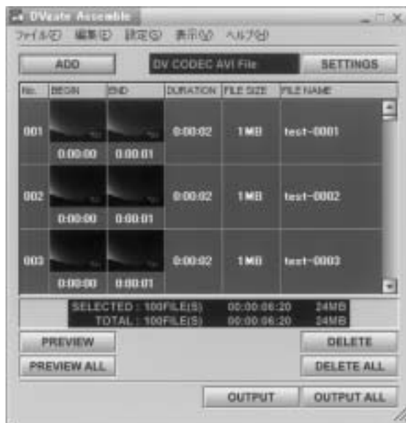
図 A-2. Sony DVgate Assemble にて指定した静止画が読み込まれたことを示すダイアログボックス。静止画のサムネイルやファイル名などが表示され、読み込まれた静止画の順番などを確認できる。また、この画面上で静止画の順番などを入れ替える事も可能である。
