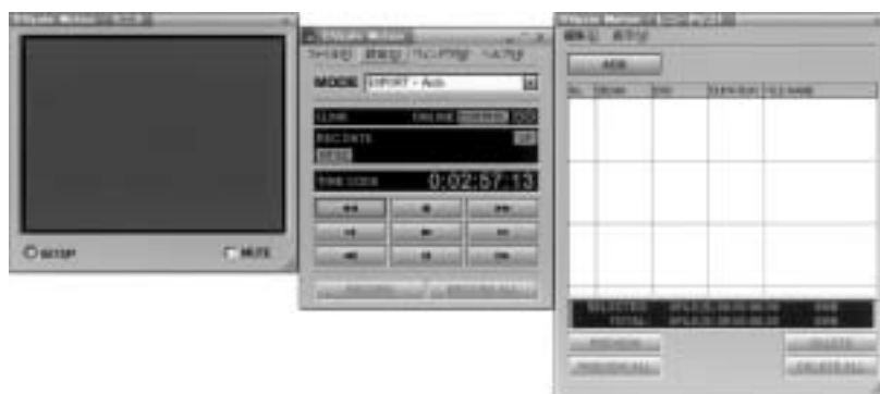
図 B-1. Sony DVgate Motion の起動後の様子．各ウィンドウは、プレビューモニター（左）、DV カメラ等機器コントロールパネル（中央）、入出力データエントリー（右）．このソフトウェアを用いて、PC 上の動画ファイルを DV カメラに転送する．
