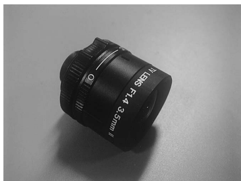
図 2-3. 今回使用したカメラレンズ(株)タムロン製 12FM35 である。
