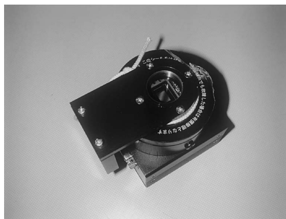
図 2-2. 今回使用した電子冷却カラー CCD カメラ (株)Bitran 製 BJ-31c である．
