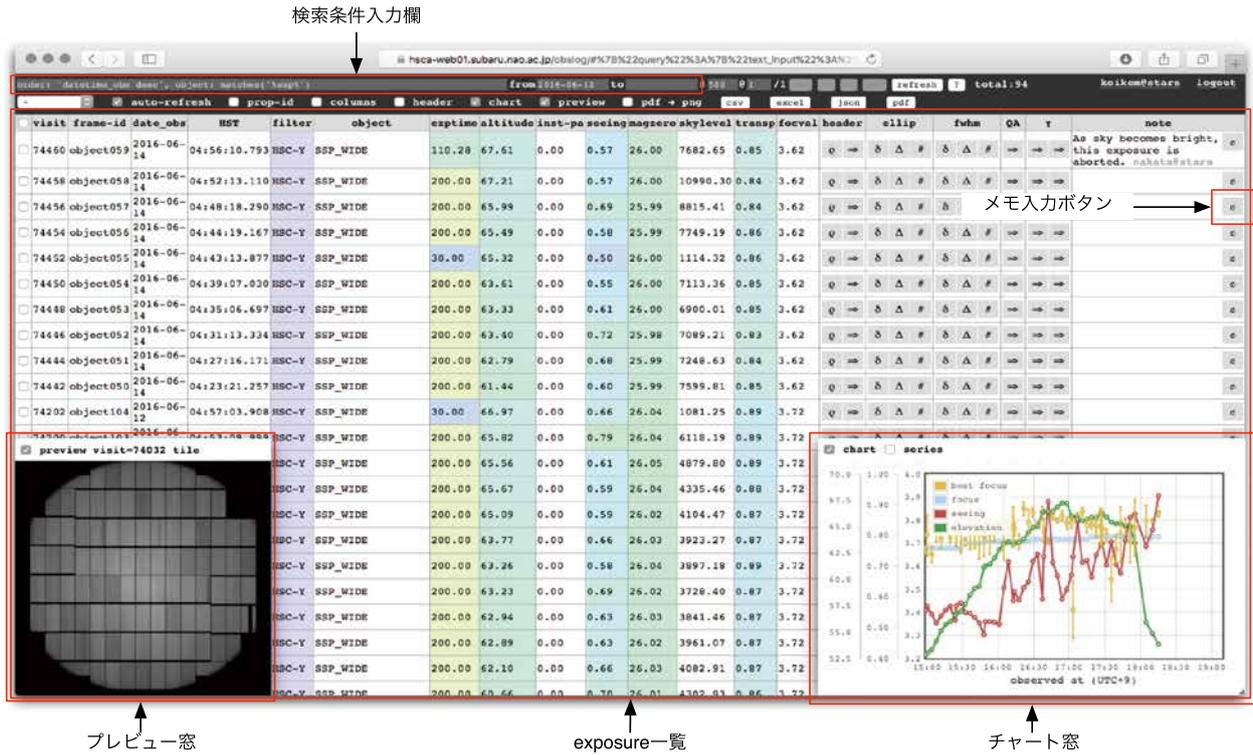
図5：HTML形式で検索結果の表示。露出一覧にはフィルタ条件入力欄にマッチした露出がリストされる。マウスカーソルを露出リスト上で動かすとプレビュー窓にカーソル下の露出の全視野プレビュー、星像の楕円率マップ、シーイングマップが表示される。またチャート窓内のデータ点をマウスオーバーすることで対応する露出リストの行がハイライトされる。なおプレビュー窓、チャート窓の右下端をドラッグすることで窓の大きさを変更できる。
