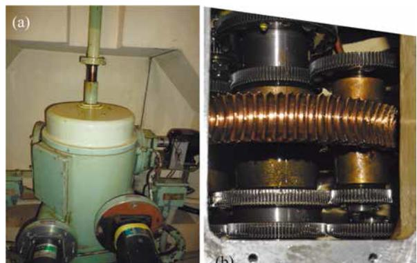
図3：改修前の赤経軸微動系。
