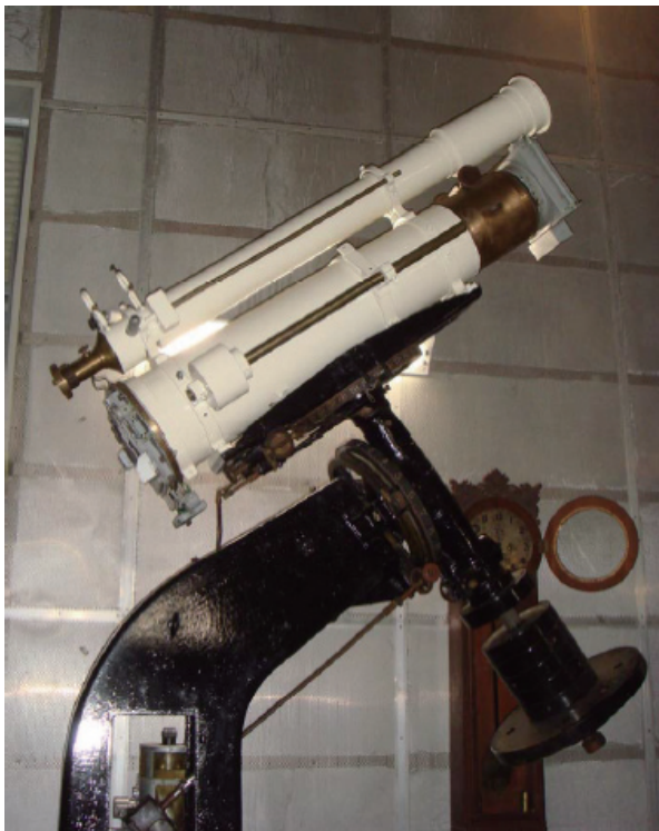
図1：現在のブラッシャー写真儀。ワーナー・スワゼー製の赤道儀に搭載されている。
