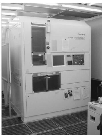
図1-1. i線ステッパ (Canon FPA-3000 i5+) 波長365nmの紫外線で露光する装置。解像度はLine and Space 0.35  $\mu\text{m}$ である。
