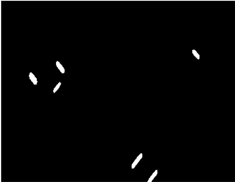
図10：制御前の星像イメージ。衛星搭載の標準的なセンサーの情報だけから姿勢制御を行なった場合、衛星姿勢は十分な精度が得られず、回転速度や軸方向がずれているために、斜めに伸びたようなイメージとなる。
