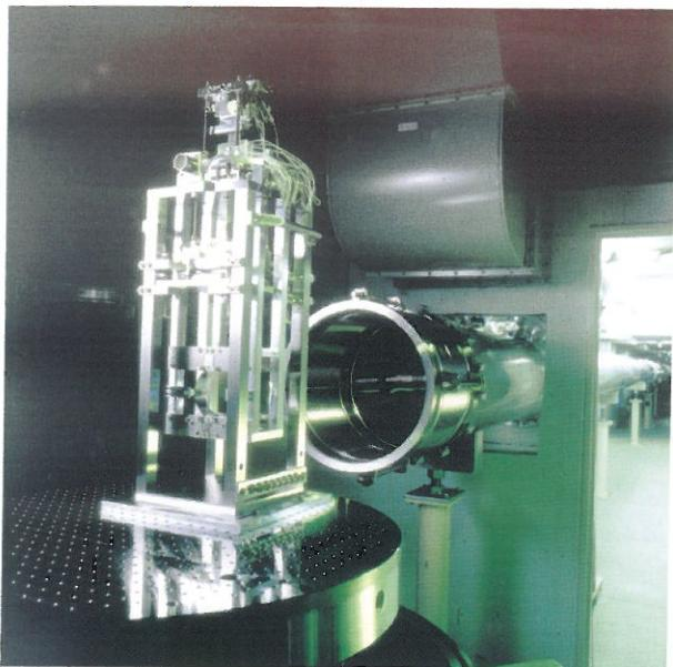
図2 300 m 真空パイプの端の真空タンク内に設置されたミラー懸架システム。タンクの蓋をはずしたところ。
