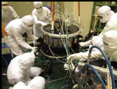
実験室で組立調整中のすばる望遠鏡超広視野主焦点カメラ
