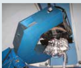
スペースデブリ観測用1m光学望遠鏡に取り付けられたCCDカメラ。Credit: JAXA
