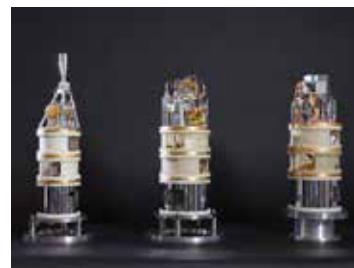
国立天文台が開発したアルマ望遠鏡の受信機。左から、バンド4（ミリ波、受信周波数 125～163 GHz）・バンド8（サブミリ波、385～500 GHz）・バンド10（テラヘルツ波、787～950 GHz）。★01
