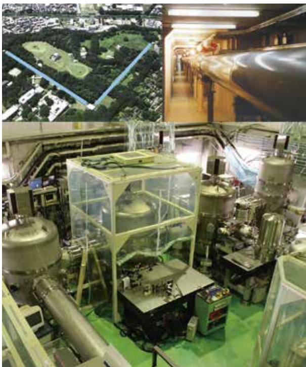
▲TAMA300, el primer detector del mundo de ondas gravitacionales en base a un interferómetro láser, actualmente sirve como banco de pruebas para el desarrollo de nuevas tecnologías para KAGRA. (Arriba a la izquierda) foto aérea, la localización de los dos túneles para los conductos de luz se muestra en azul. (Arriba a la derecha) interior de un túnel. (Abajo) laboratorio de entrada y salida lumínica.
