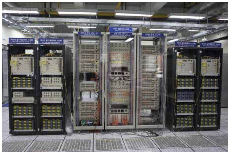
図02 日韓共同相関局のテジョン相関器。中央3つのラックに納められているのが相関ユニット、両側の黒いラックに納められているのが国立天文台が開発担当した相関データバッファとVERA記録装置 (OCTADISK)。
