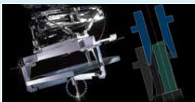
図03 交換ロボットが分割鏡を持ち上げるようす(左)。ジャッキ(棒)をダンベル形状にすることで、より早く正確に鏡を持ち上げることが可能となりました(右)。(画像:三菱電機提供)
