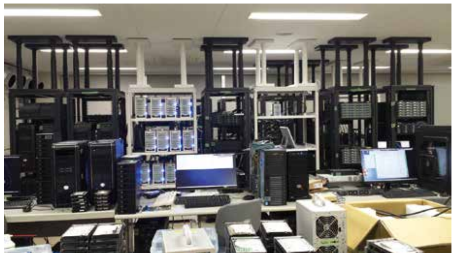
図02 相関器サーバー室内の相関器サーバー、観測データ記録装置群。
