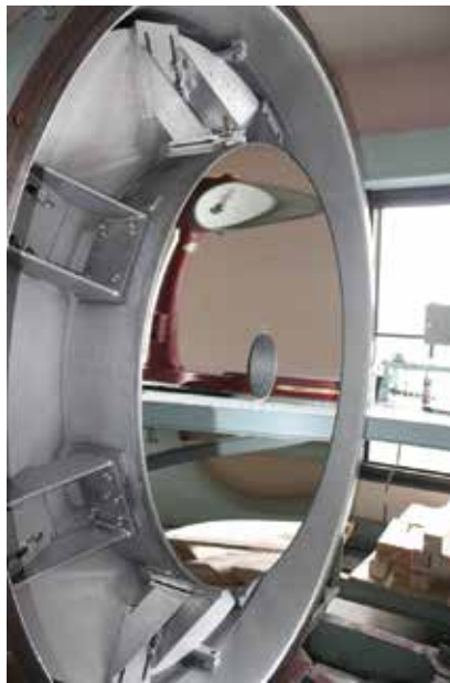
図02 再蒸着後の広島大学東広島天文台かなた望遠鏡1.5m 反射鏡。
