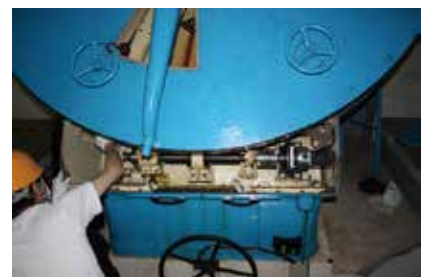
図06 望遠鏡ウォーム・ギヤへの注油作業。
