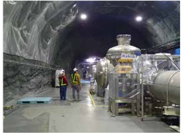
図02 左はKAGRAのトンネル内部。干渉計の長大なパイプが延びている(写真提供:ICRR)。右は、低温鏡がインストールされる真空タンクなど置かれたエリア。
