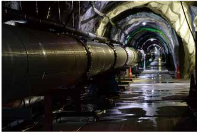
図02 左はKAGRAのトンネル内部。干渉計の長大なパイプが延びている(写真提供:ICRR)。右は、低温鏡がインストールされる真空タンクなど置かれたエリア。
