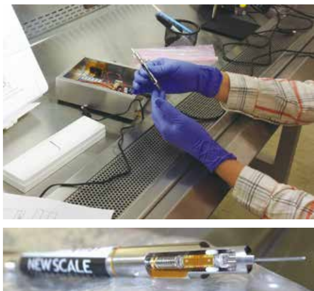
図3 光ファイバーの一端を、天体の写っている位置まで正確に動かすためのアクチュエータ。ファイバーが取り付けられ、2400本が焦点面に敷き詰められる。(上段) 納入されたアクチュエータの基本動作試験をしているところ。(下段) 先端部分の拡大写真。
