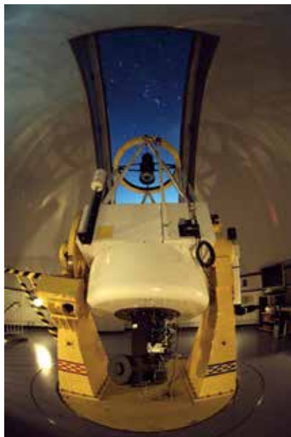
画像01 むりかぶし望遠鏡のカセグレン焦点に取り付けられた MITSuME3 色同時撮像カメラ。2008年4月に本格運用を開始しました。突発天体の代表格であるガンマ線バーストの連携観測プロジェクトに参加して成果を挙げています。
