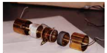
図07 磁気光学フィルター。ナトリウム蒸気セル（中央）とヒーター。
