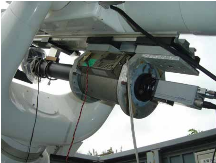
図04 新黒点望遠鏡に同架した自動フレアパトロール装置。
