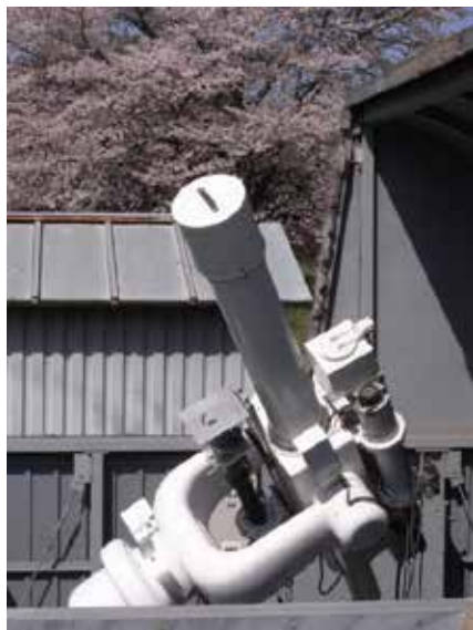
図05 新黒点望遠鏡。1998年からこの望遠鏡で太陽黒点観測を行っている。
