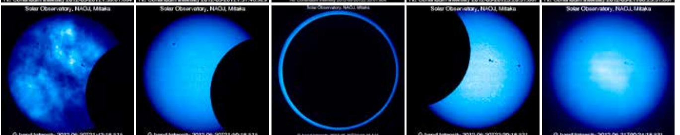
金環日食:2012年5月21日の金環日食のようす。太陽フレア望遠鏡を用いた H \alpha 線 (6563Å)、連続光 (H \alpha 線+3.5Å)、G-band (4305Å) による観測記録です。
