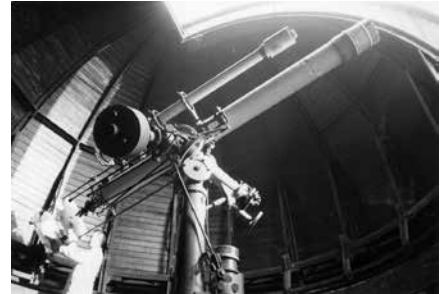
図02 太陽の白色光観測に使われたシュタインハイル製の10.5cm望遠鏡と太陽黒点スケッチに使われた口径20cm屈折赤道儀望遠鏡。スケッチをとっているのは田中幸明氏。
