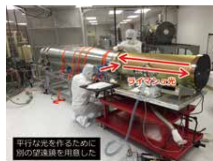
図02 ライマン \alpha 線を使った光学性能評価試験。
