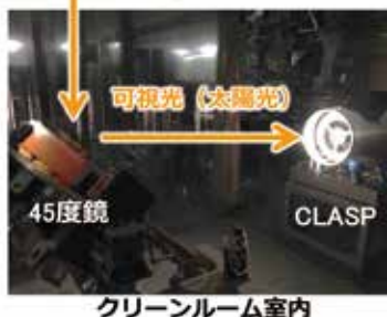
図01 ヘリオスタットを用いた太陽光迷光試験。
