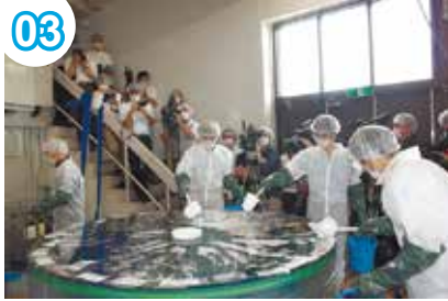
水酸化ナトリウム溶液で古いアルミメッキを溶かします。今年もたくさんの方の地元マスコミの皆さんが「岡山の梅雨の風物詩」の取材に來られました。
