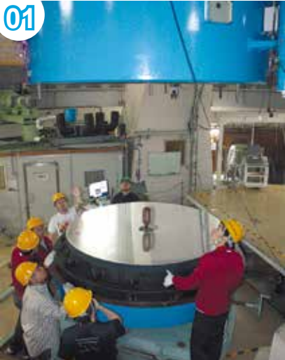
主鏡を鏡筒から取り外します。
