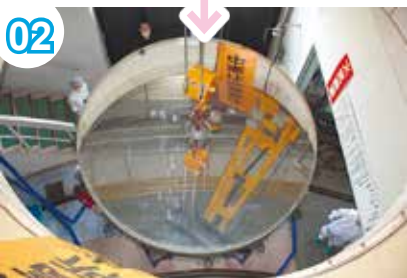
クレーンで2階から1階の作業場へ主鏡を下ろします。
