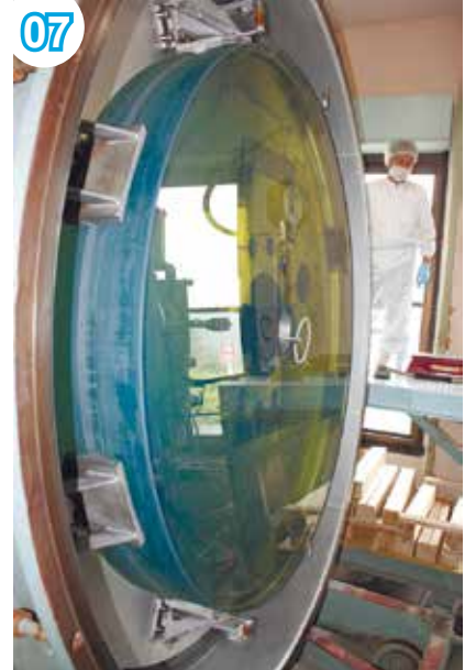
蓋を立て真空蒸着釜を閉じます。
