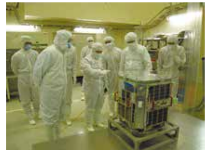
組み立てが完成した Nano-JASMINE 衛星の打ち上げ実機 (国立天文台先端技術センターのクリーンルームにて)。衛星のサイズは50cm立方、重さは約35kg。
