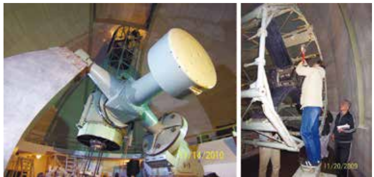
図3 (左) コッタミア観測所の188cmは、岡山の188cmと姉妹機。(右) 副鏡支持部周りを調べる国立天文台スタッフ。
