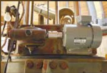
(上) 改修されたハイテクドーム内、再装着されたシーロスタットの2枚の平面鏡を操作し、太陽光を塔に導く。(下) 駆動系の改修ではツァイスの機構をあきらめ、サーボ系を導入。一度はウォームギア軸の破断があった第2鏡上下駆動部。
