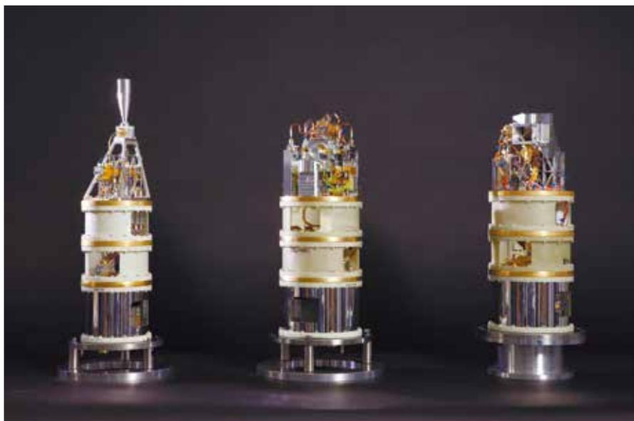
図02 国立天文台が開発したアルマ望遠鏡の受信機。左からバンド4、バンド8、バンド10。
