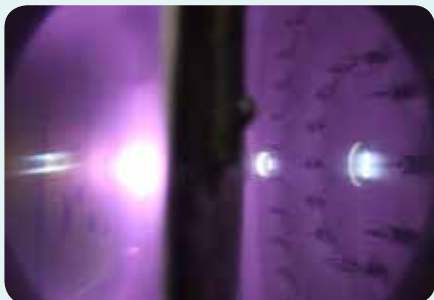
▲蒸着釜にアルゴンガスを注入し、イオンボンバードを約20分間行う。"の"の字は白く発光し、紫色の放電により、主鏡表面が最終洗浄される。
