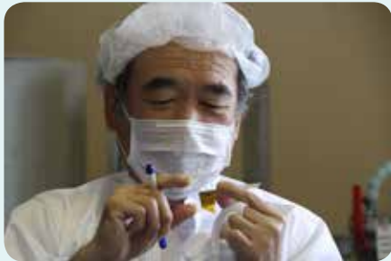
▲主鏡周辺に設置していたテスト用プレパラートの表面にスコッチテープを貼り剥がしてみる。蒸着膜が剥がれなければ成功。
