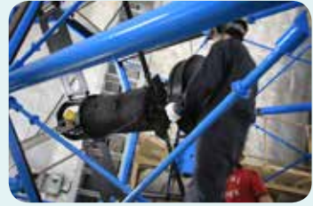
▲鏡筒内に入り込み、副鏡や第3鏡、パッフル、バランスウェイト、その他観測装置などを慎重に取り外していく。
