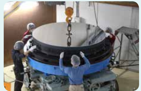
▲主鏡はクレーンで2階に釣り上げられ、主鏡セルに収められる。
