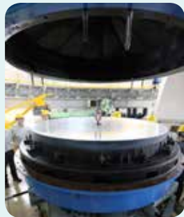
◀主鏡セルの留めボルトを外し、昇降床をゆっくり下ろす。現れた主鏡には、うっすらと白い埃やチリが見える。主鏡中心の穴から突き出しているのは、主鏡吊り上げ用の治具。
