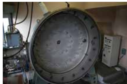
▲岡山の蒸着装置のフィラメント配置。内側12本、外側24本。全部で36本ある。
