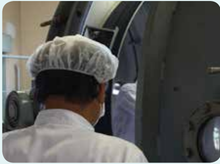
▲蒸着終了後、真空装置を止め、バルブを開き、蒸を開ける。うまく蒸着されているかどうか、ドキドキの瞬間。
