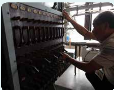
▲アルゴンガスを止め、蒸発させるブリュエットフィラメントを昔ながらのナイススイッチで選択する。蒸着は数回に分けて行われ、平均に蒸着されるよう、各回に蒸発させるフィラメントの位置もあらかじめ決められている。
