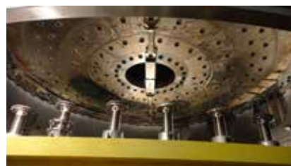
▲すばるの蒸着装置のフィラメント配置。上面に見える穴の上に電極とつながったフィラメントが装着されている。全部で288本ある。すばるの蒸着は、下に鏡材が置かれ、上から蒸着する仕組みになっている。これらの穴は、蒸着の際に、各フィラメントからのアルミが飛び範囲を制限するためのものである。
