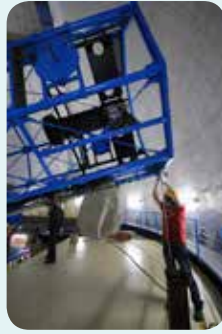
◀鏡筒から各種装置類を取り外すと、バランスが崩れ、鏡筒が持ち上がるため、鏡筒の先にロープを結びつけて固定しておく。
