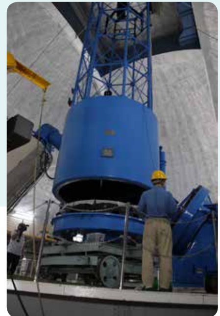
▲主鏡用台車を鏡筒の下まで移動し、昇降台で慎重に上げていく。中央に来ていることを確認しながら、主鏡セルを鏡筒にはめていく。
