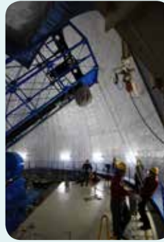
▲主鏡を取り外すために鏡筒を立てる。鏡筒の先を固定しているロープを慎重にくり出しながら、ゆっくりと鏡筒を立てていく。
