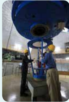
▲鏡筒が直立したら、底部に取り付けられているダミーウェイトを、専用台車に取り外す。
