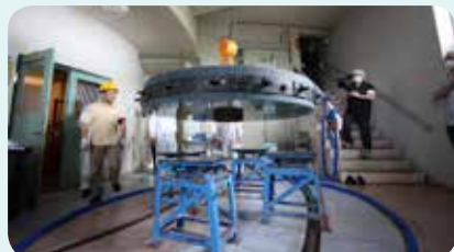
▲洗浄台座に降ろされてきた主鏡。洗浄台座を取り巻く青のホースは、洗浄の際に流れ落ちた廃液が、周りに流れ出さないようにと設置した防水堤。長年の知恵の一つ。
