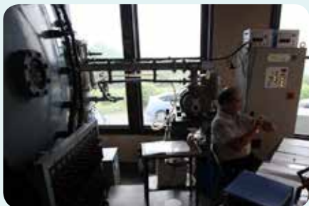
▲ロータリーポンプで粗引きをし、順にメカニカルブースターポンプ、He冷凍式クライオポンプ等で蒸着釜内の真空度を上げていく。
