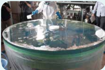
▲メッキ剥離。中央の穴に蓋をし、10%水酸化ナトリウム溶液を鏡端から万遍なく掛けていく。
