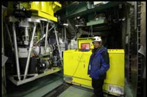
◀カセグレン観測装置待機室。私のバックの黄色い装置が自走台車です。2トンのカセグレン観測装置をこの待機室と望遠鏡の間で運搬します。左の観測装置はスタンバイしている MOIRCS です。 ▶ランチ後の休憩風景。マッサージチェアで休憩中。さあ午後もがんばるぞ！
