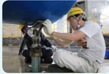
▲望遠鏡のバランスウェイトを固定金具に取り付け、赤経軸の回転を固定する。
