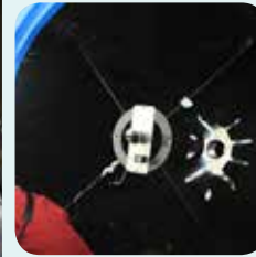
▲主鏡前にモニタカメラを取り付ける。主鏡取り外しの際に、位置確認に使用する。
