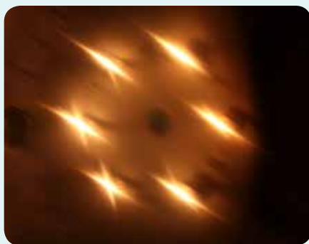
▲蒸着中。主鏡面にアルミが蒸着されるに従い、反射して見えるブリュエットフィラメントの様子もくっきりと見える。
