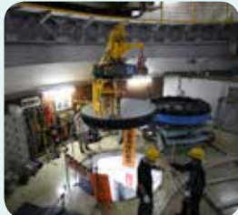
◀主鏡セルの留めボルトを外し、昇降床をゆっくり下ろす。現れた主鏡には、うっすらと白い埃やチリが見える。主鏡中心の穴から突き出しているのは、主鏡吊り上げ用の治具。
