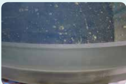
▲岡山天体物理観測所の188cm望遠鏡は、1959年に作られたイギリス製の鏡。当時は、気泡のない大型ガラス鏡を作る技術が確立されておらず、鏡の中に多数の気泡が見られる。
