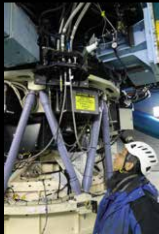
◀ "私の愛した機械たち" カセグレン焦点に装着された FOCAS です。私が見ている自動着脱コネクタはヘリウム、冷却水、エアーを供給している流体コネクタです。
