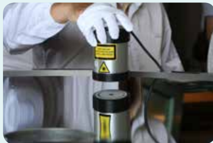
▲反射率の測定。蒸着前に測定した反射率と比較し、反射率の向上を確認。
