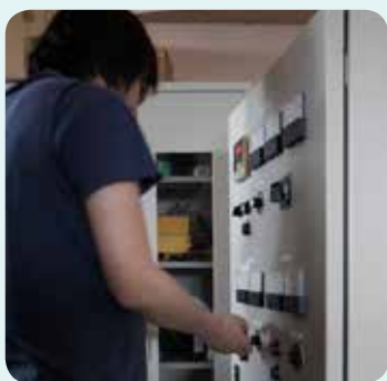
▲定電流装置で、ブリュエットフィラメントに流す電流値をセット。電流を流すと蒸着が始まる。
