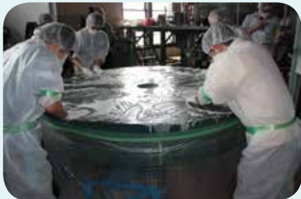
▲重曹研磨。腰を入れてゴシゴシ磨く。結構な重労働。
