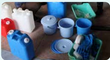
▲洗浄で使用した薬剤の廃液処理や装備の洗浄も大切な仕事。中和希釈したのち、使い捨ての洗浄具や廃液は収集され、専門の処理業者に渡される。
