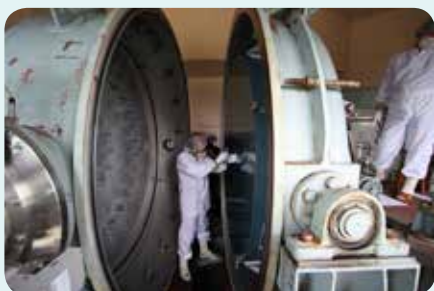
▲主鏡を設置した蒸着釜の蓋を立て、イオンボンバード用電極通称"の"の字を設置する。
