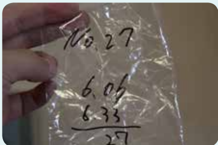
▲プリウェットフィラメントは、蒸着前・蒸着後の重量を記録しておき、どの位置のフィラメントから、どれだけのアルミが蒸発したかを推定する。
