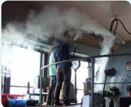
▲十分に真空度が上がったら ( 10^{-5} Torr)、マイスナーコイルに液体窒素を注入。コイル出口からは冷却された水蒸気が勢いよく噴出する。真空度は一気に上昇し、 6 \times 10^{-6} Torr に達する。
