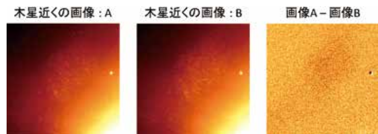
図4 すばる望遠鏡搭載近赤外線分光撮像装置 IRCS にて観測した木星近くの画像。木星は視野の右下外に配置しているが、その迷光が視野内に侵入してきている(画像AおよびB)。木星と視野の位置関係を固定して観測する事で、迷光はきれいに差し引ける(右の差分画像)。視野の右側に移っているのは背景の恒星で、これは木星に対して動いているので、右の差分画像ではスレが見えている。
