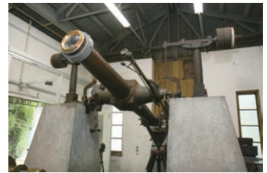
01:シュタインハイル製レンズを搭載したレプソルド子午儀。
