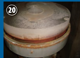
20 主鏡をセルから浮かせたところ (⑩)。主鏡をセルから取り出した
