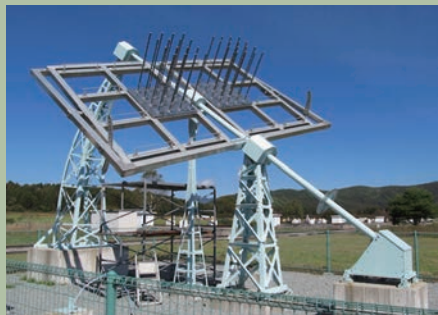
形の復元だけでなく、1.4GHz帯(波長21cm)のスタックアンテナと受信機を取り付けて、太陽からの電波を受信することもできます。→p10参照(国天ニュース2011年11月号・2007年10月号に関連記事があります)
