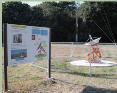
三鷹の常時公開エリアで太陽電波受信の実演ができるように、赤道儀架台に載せられ、17GHz帯、7GHz帯の太陽電波を受信することができます。→p10参照(国天ニュース2012年7月号に関連記事があります)
