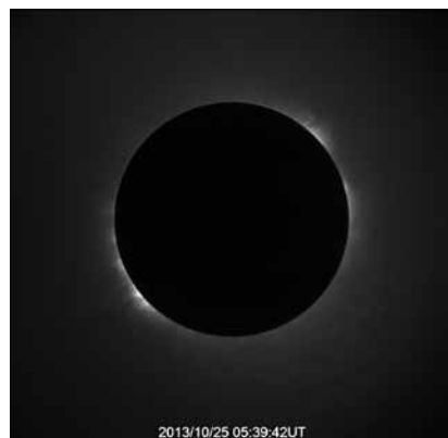
図3 10月25日に撮影されたファースト・ライト画像。中央の黒い円が太陽を隠しているオカルティングディスク。
