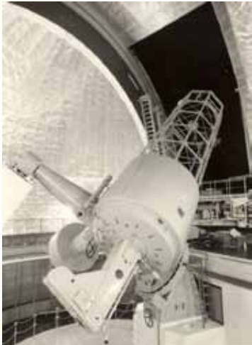
写真1 開所当時の188cm反射望遠鏡
