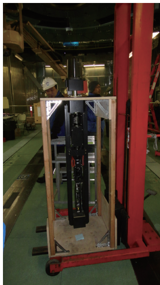
図 28 身長 150cm、体重約 80kg のアクチュエータを交換するための台車。
