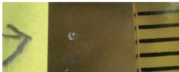
図14 鏡面の瑕疵とは、たとえばこういうものを見つけるのです。物差し之最小目盛りは1ミリメートル。
