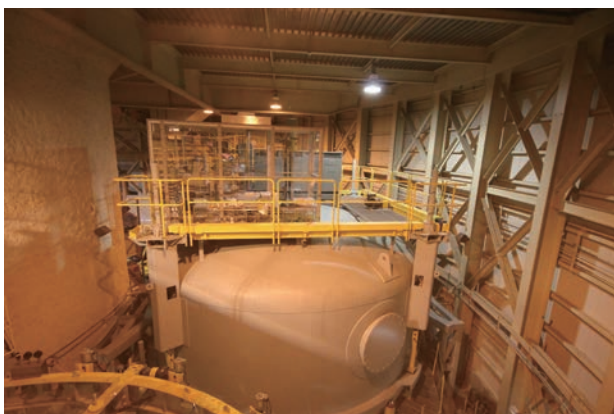
図17 主鏡ハンドリング装置の上部から蒸着装置全体を撮影。「頼むぞ蒸着装置、反射面をよろしく」。
