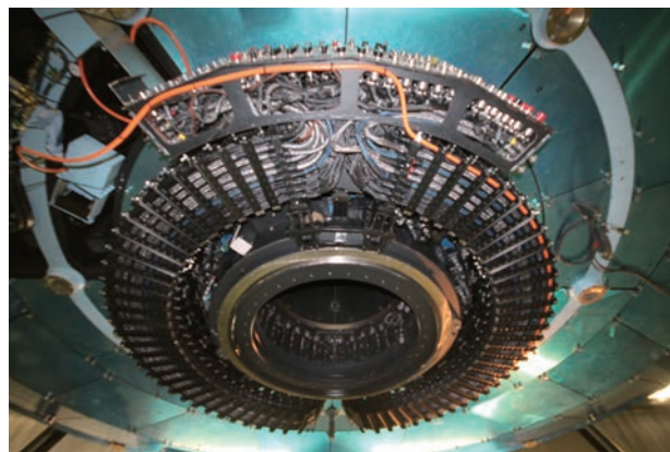
図03 ケーブル巻き取り層 (電力、光ファイバー、イーサネット、冷媒配管などを望遠鏡から観測装置に受け渡すための巻き取り部分) のようす。
