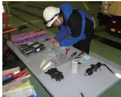
図11 交換部品の数々。作業の順に、取り上げやすい向きで…周到な準備中の職員。
