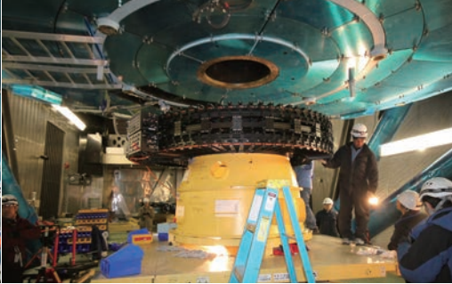
図05 ケーブルラップ層を台車で受け取って取り外し完了。カセグレン装置・周辺機器がすべて取り除かれて、むき出しの主鏡セルの裏面が現れた。
