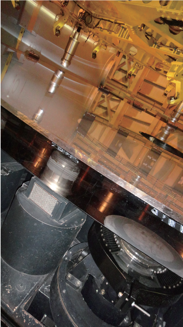
図29 右下が主鏡固定点。ちなみにこの鏡面はメッキやり直し前の画像なので、鏡面の白っぽさを確認できる。左上はアクチュエータの支持部。
