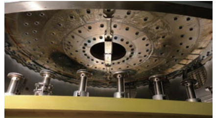
図19 蒸着装置台車には、主鏡が載る際のスプリングサポートが林立。上部に見えるのは、フィラメントからアルミニウムが蒸発してくるための穴、そしてグロー放電のためのバー。
