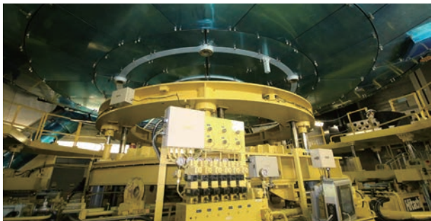
図09 黄色い主鏡台車が主鏡セル下部に向かって上昇中。主鏡+主鏡セルからなる主鏡部を受け止める。
