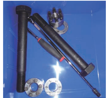
すばる望遠鏡の主鏡セルと望遠鏡本体をつなぎとめているボルト (くわしくは12ページの記事へ)。
