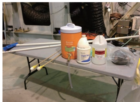
図12 主鏡の油污れ除去には、洗剤（白いボトル）をオレンジ色のタンクに入れ、鏡面に流す。左端に写っている巨大な耳かきのような棒は、主鏡のくぼみにたまったゴミや洗剤を掻き取る秘密兵器。
