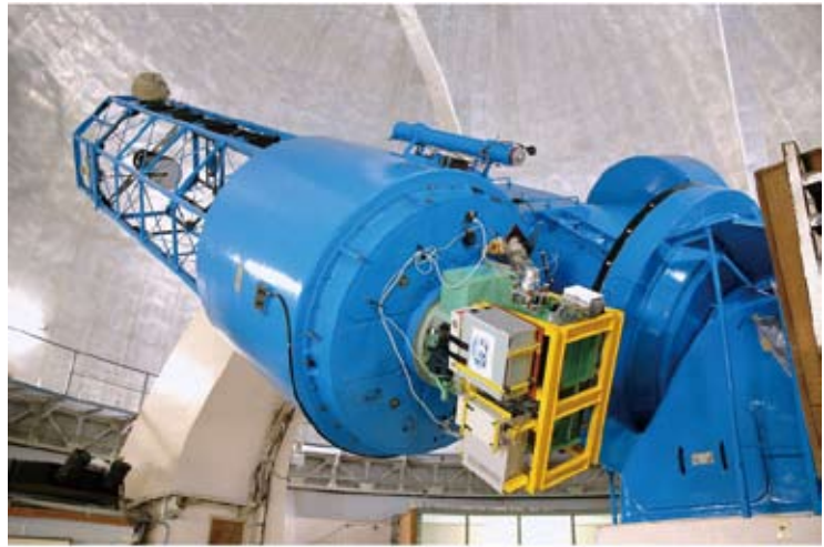
図2 岡山観測所の188 cm望遠鏡と、カセグレン焦点に付けられた近赤外線観測装置 ISLE。
