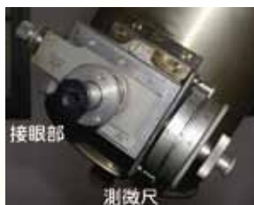
図5 眼視天頂儀に使用される接眼部のマイクロメータ(測微尺)。
