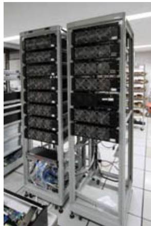
02 (左) GRAPE-7システム。むき出しの状態……ではなく、ケースに納められている。そのためがフロントに空冷用の大きなファンを3つも搭載。(上)は、GRAPE-7の内部(修理中)。ケースに入っているもの、天井や背面はフリーなので、アクセスはしやすい。
