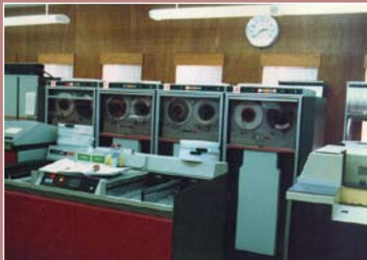
写真03 1980年3月に東京天文台に導入されたUNIVAC 1100-80B。このシステムの主記憶容量は4MB、磁気ディスク容量は1GB、浮動小数点演算性能は3.7kFLOPSとされる。
