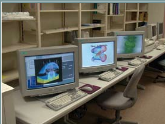
写真10 写真09のVPP5000システム一式と同時に調達されたデータ処理・可視化用計算機システムであるSGI PowerOnyx2 IR3。天文総合情報棟二階にある共同利用計算機室に設置された。
