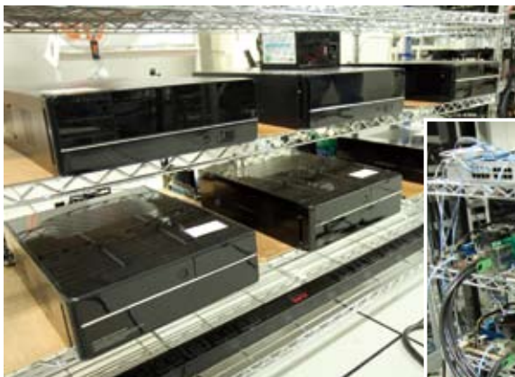
03 GRAPE-9の筐体外観。将来的には黒ケースに納められたGRAPE-9が、この写真のように金属ラックに並べられる。
