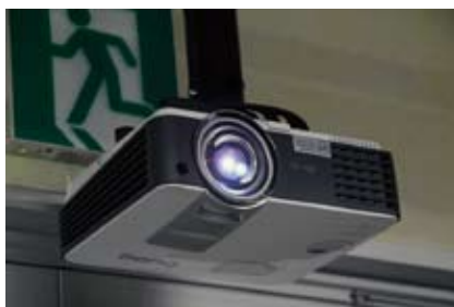
02 アテルイ本体へのプロジェクションマッピング用プロジェクター。Macで再生される動画がこのプロジェクターを通して投影される。
