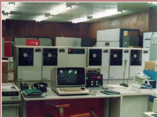
写真04 1983年5月に東京天文台に導入されたFACOM M-380Rもしくは1985年4月に更新されたFACOM M-380R/MSP（この写真がそのいずれであるか不明）。M-380RおよびM-380R/MSPの主記憶容量は16MBおよび24MB、磁気ディスク容量は10.7GB（双方とも）、浮動小数点演算性能は12MFLOPSおよび16MFLOPSとされる。
