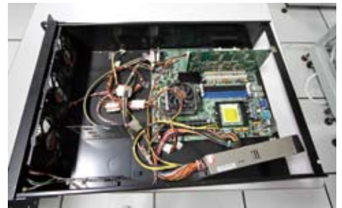
02 (左) GRAPE-7システム。むき出しの状態……ではなく、ケースに納められている。そのためがフロントに空冷用の大きなファンを3つも搭載。(上)は、GRAPE-7の内部(修理中)。ケースに入っているもの、天井や背面はフリーなので、アクセスはしやすい。
