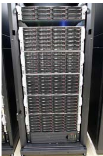
02 ファイルサーバ。RAID6で冗長化。サーバ1台あたり4TBのHDDを36台搭載し、120TBのデータストレージを構成。
