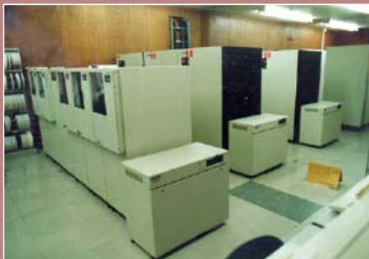
写真05 1988年3月に東京天文台に導入されたFACOM M-780/10S。このシステムの主記憶容量は32MB、磁気ディスク容量は15.1GB（国立天文台になった1993年3月に21.1GBに増強）、浮動小数点演算性能は36MFLOPSとされる。
