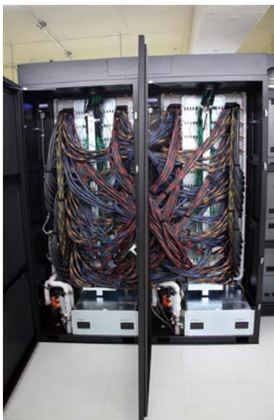
05 アテルイの背面を開けたところ。各CPUを多数のインターコネク（高速回線）が繋いでいる。
