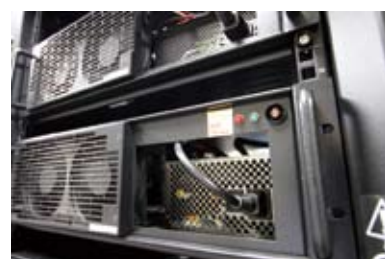
03 解析サーバ。サーバ1台あたりメインメモリ64GB、12コアCPUが2基搭載されている。
