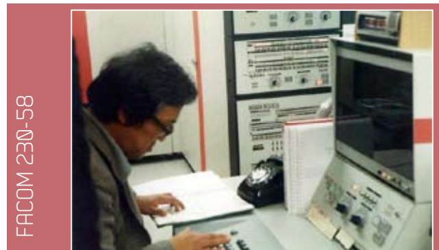
写真02 1976年1月に東京天文台に導入されたFACOM 230-58を使って計算作業を行う古在由秀・東京天文台教授 (当時、すでに東京天文台人工衛星国内計算施設長などを歴任し、後の東京天文台および国立天文台長)。このシステムの主記憶容量は770KB、磁気ディスク容量は400MB、浮動小数点演算性能は800 FLOPSとされる。
