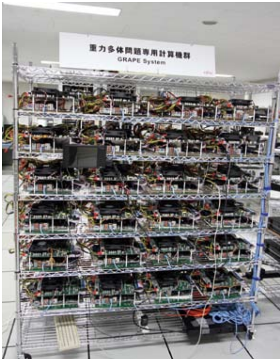
01 GRAPE-DRシステム。計算サーバー同様にむき出しの状態では無く、メタルラックに納められている。2階建てのボードが特徴。
