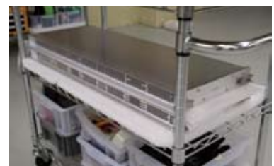
04 ブレードケースの外観。故障が生じた際には、ブレードを引き抜いて部品を交換する。側面には空冷用の穴が多数あいている。
