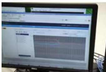
09 電力量の推移グラフ。計算が集中すると電力消費も増大するので、つねにモニターされている。
