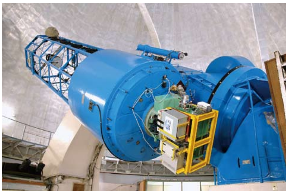
図1 岡山人体物理観測所 (OAO) の188 cm 反射望遠鏡に取りつけられた近赤外線観測装置 (ISLE)。
