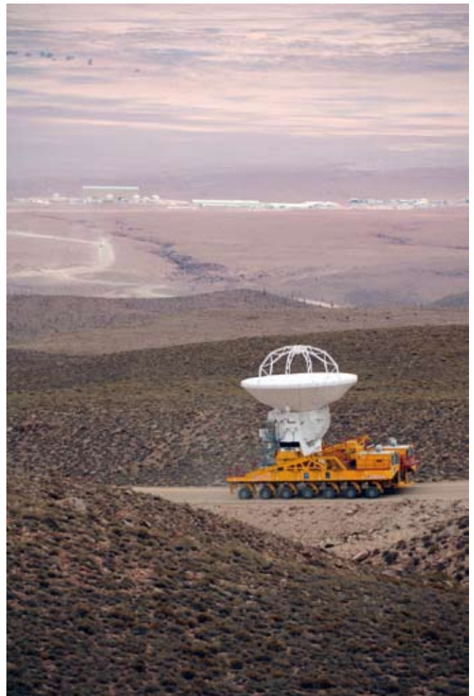
写真3 標高5000mの山頂施設に一番乗りを果たした日本の12mアンテナ。合同アルマ観測所に引き渡されたアルマ望遠鏡第1号アンテナでもあります。
