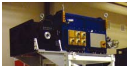
図2 惑星探査用赤外線カメラHICIAO(ハイチャオ)。
