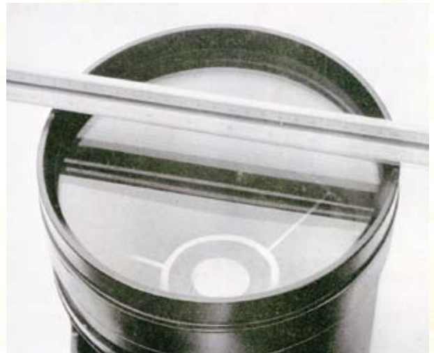
図3 表紙写真は、補正レンズの上の三角スケールが置かれ、その反射像が見えるように撮影されている。反射像をよく見ると補正板の曲面が見え、4次曲面であることが分かる。
