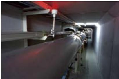
TAMA300は地下に設置された東西300m、南北300mの真空パイプで構成されたマイケルソン型干渉計で、直径40cmの真空パイプの中を走るレーザー光線による超精密な測距によって宇宙空間のひずみを測定します。
