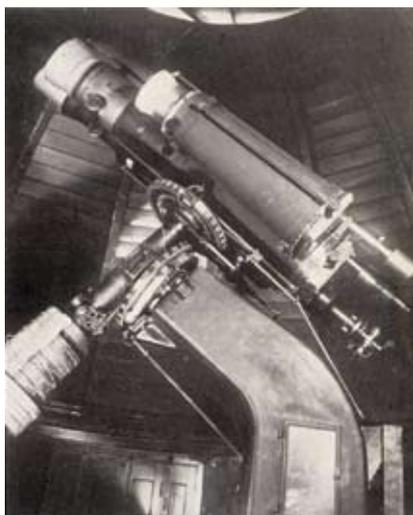
図2 専用のワーナー・スワゼー製赤道儀に載せられたブラッシャー天体写真儀（奥の長い鏡筒）。
