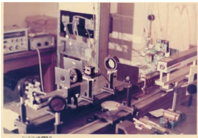
図10：音響光学型電波分光計の128チャンネル試作機(三鷹、1976年)。宇宙電波用では世界初で、このまま6mミリ波望遠鏡に同軸ケーブルで繋ぎ、非常に安定に観測できた。野辺山45m鏡の超大型電波分光計の原型である。
