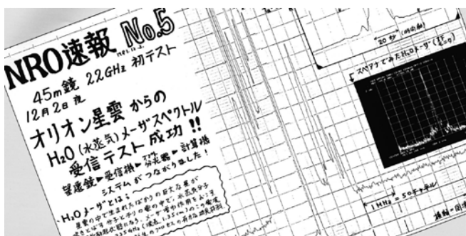
図5：オリオン星雲の水蒸気メーザー初検出を伝える手書きNRO速報第5号。この時は22GHzと比較的長波長で、向けるや否や即受信の楽勝だった。上記1月の「ミリ波受信テスト」は88GHzのSiOメーザの受信試験で、苦労した。
