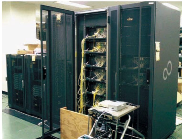
ALMA の ACA 相関器と同じタイプの新分光計 SAM45。最大 2 GHz × 16 IF の周波数範囲をカバーできる（14 ページ参照）。
