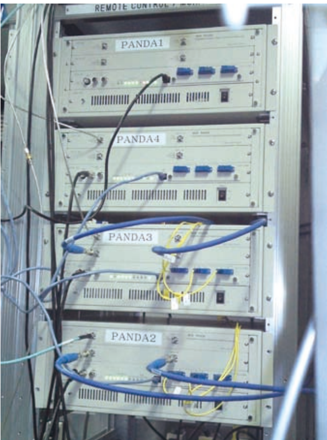
水沢 VLBI 観測所と協力して開発した高速 A/D 変換機 PANDA。
