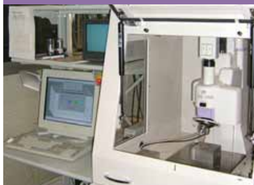
非接触式3次元測定器
