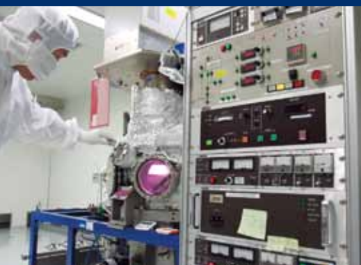
クリーンルームとSIS素子製造装置
