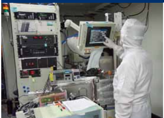
クリーンルームとSIS素子製造装置
