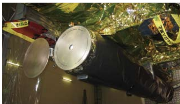
「ひので」衛星に取り付けられたXRT。サンシールド (銀色の円板部分) の周辺にある細い円弧状の隙間が軟X線の開口。
