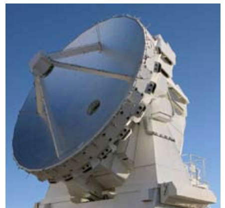
7m アンテナの主鏡部。アンテナの底部の縁を取り囲むように 2 つ 1 組の「空冷パイプ穴」が見える。
