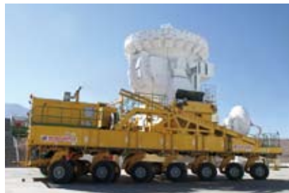
7mアンテナの積載完了。多軸の車輪群を自在にコントロールして、コンパクトな斜め横走行で作業エリアから発進！
