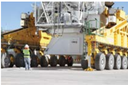
OSFで調整された日本の7mアンテナをAOSへ運ぶための荷積み作業。コの字型の車体に挟み込むようにアンテナを持ち上げて積載する。
