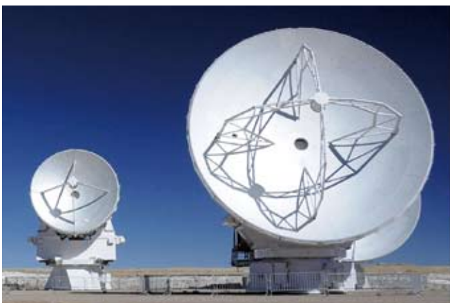
(左上画像) 日本が製作を担当する「いざよい」の7m(左)と12m(右)のアンテナ。(右上画像) 欧州の12m(左)と北米の12m(中)と日本の7m(右奥)のアンテナ。同じ12mアンテナでも、副鏡の支持アームの構造が、欧州は直棒、北米は取り付けが主鏡の縁まであり、日本はよりコンパクトな構造、とそれぞれ異なっている。
