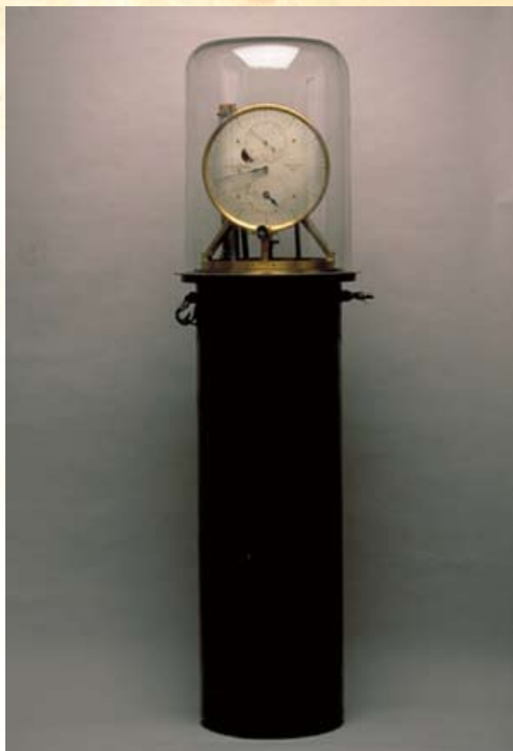
図1 No.461号の全体像。文字盤部は半球状のガラスで覆い、下の振り子部分は管に納められている。
