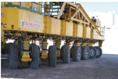
片側14個のタイヤは2個1対で、7つ対がそれぞれ独立に動く。これによりその場での回転や横移動など、自在の走行が可能。
