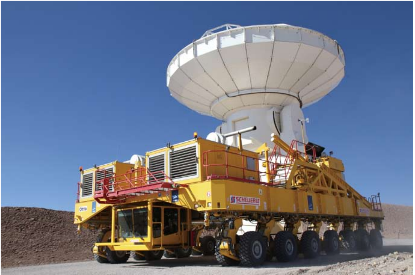
トランスポーターは、車長20m・車幅10m・車高6mで、片側14個・計28個のタイヤを備える巨大メカ。100トンのアンテナを載せ、標高差2100メートルのダート道を行き来するさまは、まるでサンダーバードの世界。ドイツにある特殊車輛の世界的メーカー「SCHEUERLE (シヨイエレ)」社製である。
