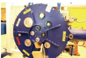
受信機ユニットにセットされた各超伝導受信機の受信面。10バンドがカバーされる。
