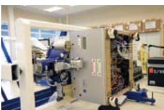
各アンテナに取り付けられる受信機ユニット。OSFのラボで調整中のもの。
