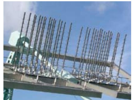
写真3：八木アンテナ32本からなるスタックアンテナ。
